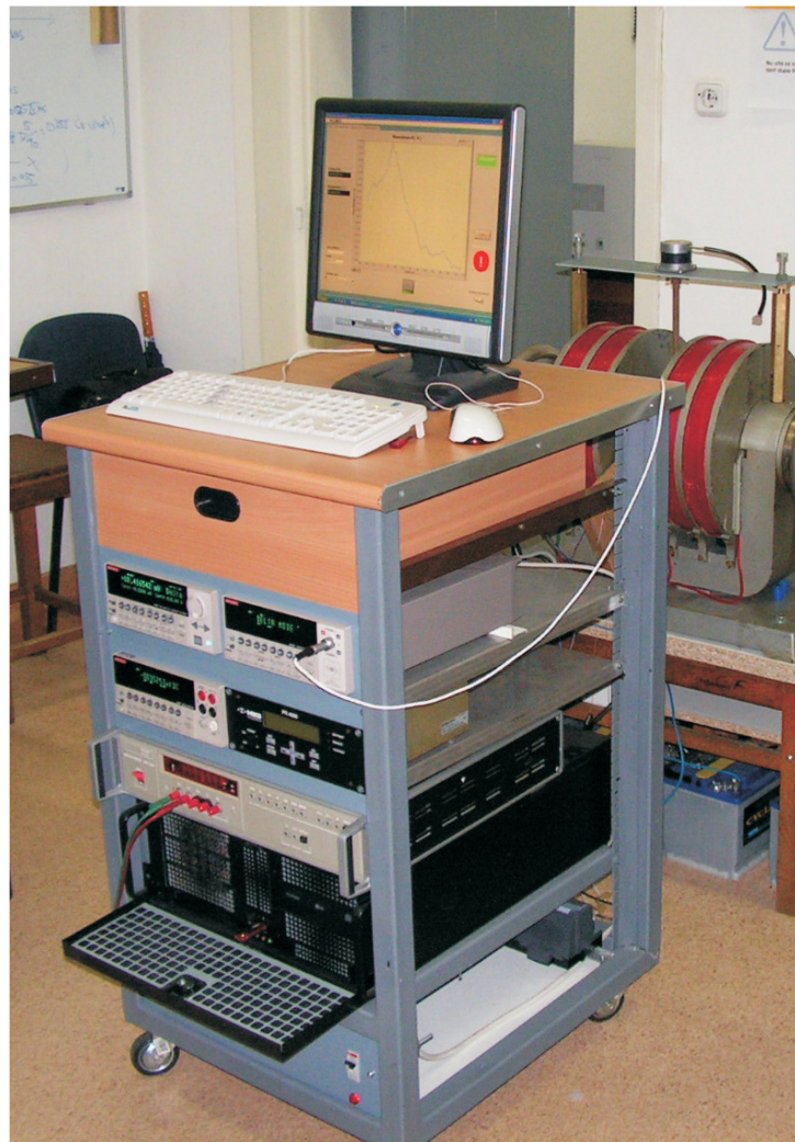
Fig. 3.13: Instalația de măsurat rezistențe în câmp magnetic
